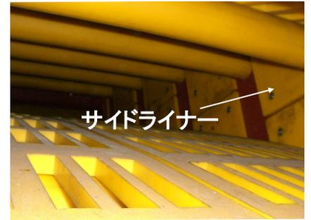
自社製振動篩MULTI-VIB(マルチビブスクリーン)は縦張りフック(原料の流れと同方向に緊張)を採用しております。網のほかに投入・排出用落ちロライナー、側板サイドライナーや網受けサポートパイプ外周保護ライナーとしてタフデッキをお客様のご要望サイズに製作いたします。機械構造に合わせた寸法や仕様でウレタンを加工しますので摩耗が気になる箇所や機械部品の保護カバーとして非常に活躍します。
