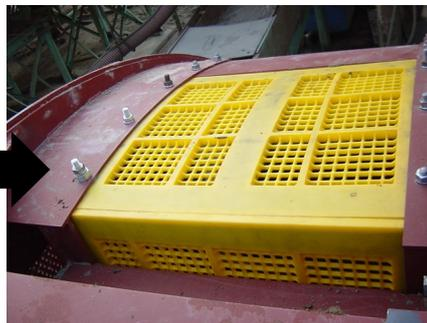
一部だけ摩耗で擦り減ってしまった箇所もサイズを合わせたタフデッキを取り付けて修復させます。
